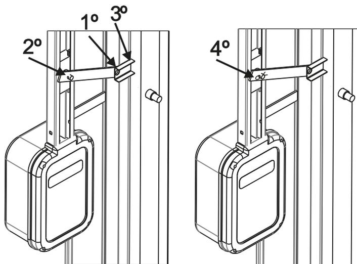
**Figura 6:** 1º Fixar com um pingo de solda o “Cavalete com Pino” no “Braço de Destramento” o “Suporte Dobrado”. 2º Posicionar o “Braço de Destramento” sobre o pino do “Fechamento da corrente”. 3º Com o portão todo fechado, fixar com pingo de solda o “Cavalete com Pino” na parte móvel do portão. 4º colocar o “Espelho do Braço” sobre o “Braço de Destramento” e colocar o pino de “Travamento do espelho do Braço”.
